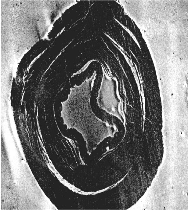
化學紙漿及機械漿在應用時，通常經打漿至理想範圍以求取對紙張強度性質之改善。打漿會導致化學漿打鬆化學漿細胞壁的構造（內部帚化）及表面（外部帚化）。
